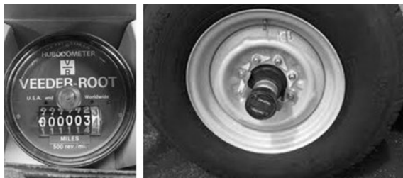
【図表35】 車輪装着型走行距離計（hub odometer）（public use）
